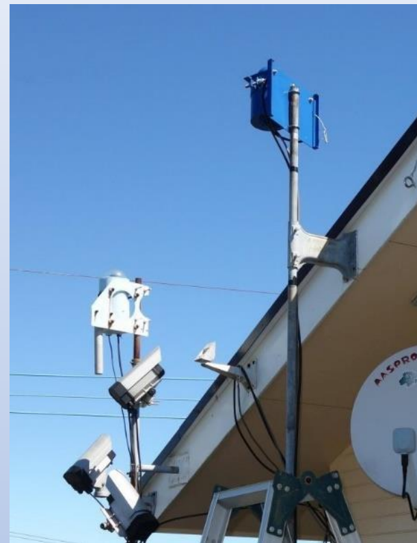
図1 左) カメラ部：塩ビ管とアクリルドームを組み合わせてGigEカメラに魚眼レンズをつけている。 右) 観測風景：右のポールの上のカメラが今回報告した新しいカメラ、左のポール上が初代の全天カメラ。
